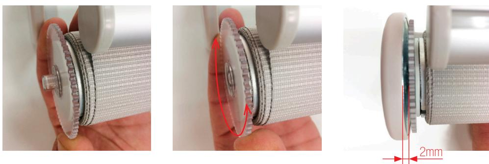
**NOTA:** La separación adecuada entre soporte y el "one touch" debe ser de 2mm. De no ser así, retirar el enrollable y desplazar los soportes lo necesario para conseguir esta distancia.
