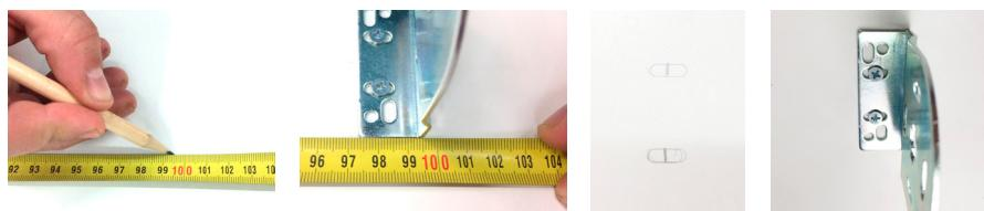
**NOTA:** Es importante fijar los soportes bien centrados, de este modo, si se ha producido alguna desviación en la medida, se pueden desplazar para ajustar la posición.
